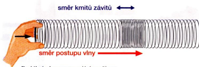
Podélná vlna postupující pružinou
